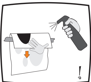
7.- Pulverice con agua la parte adhesivada del vinilo.
