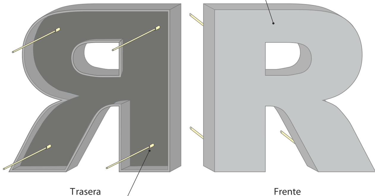
Varillas de acero para montaje.
