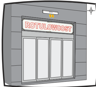
2.- Posicionar la plantilla de papel sobre la pared que va a montar las letras. Pegarla con cinta.
