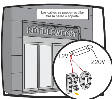
7.- Una vez colocadas todas, conectar cada letra al transformador a través del cable lateral.
